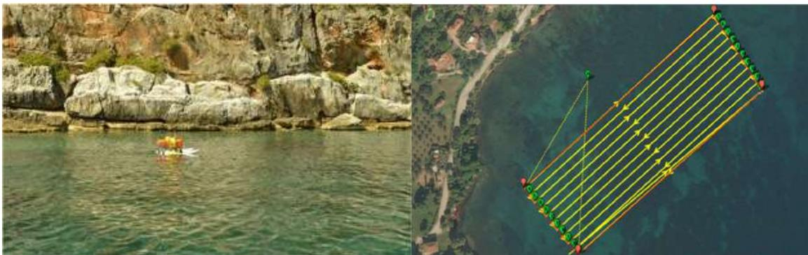
**Figura 76** – Veicolo ASV DEVSS con rappresentazione della griglia delle rotte dei vari transetti.
