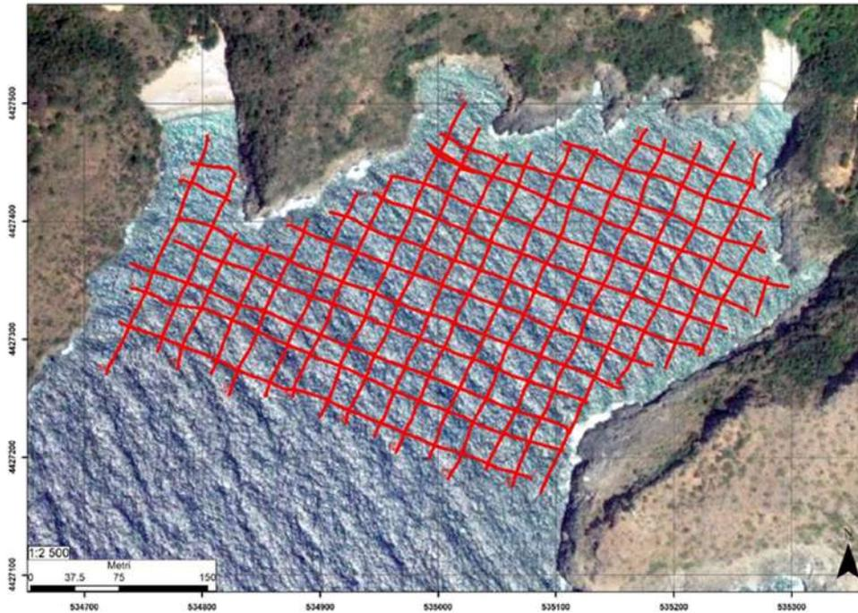
**Figura 32** - Linee di acquisizione delle indagini mediante Sub Bottom Profiler.
