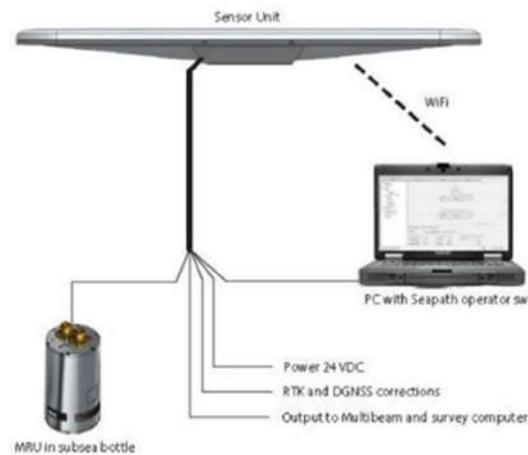
**Figura 8 - Sistema girobussola/MRU Seapath130 con MRU 5**
