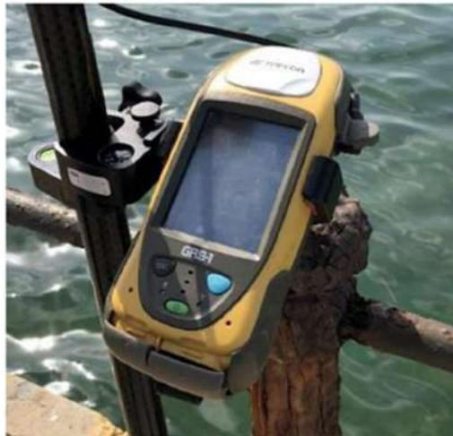
**Figura 6 - Ricevitore RTK Topcon GRS-1.**
