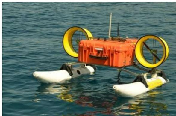
**Figura 73** - Veicolo Autonomo di Superficie DEVSS
