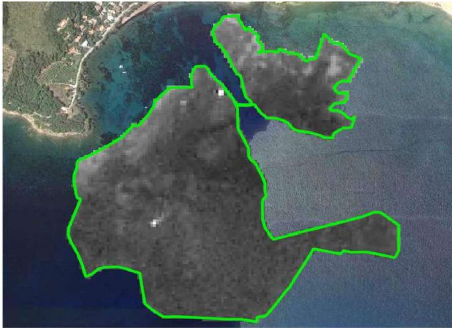
**Figura 5** - Porzione di immagine corretta della colonna d'acqua raffigurante la sola prateria di Posidonia. In verde la traccia dello SHP impiegato per il ritaglio.
