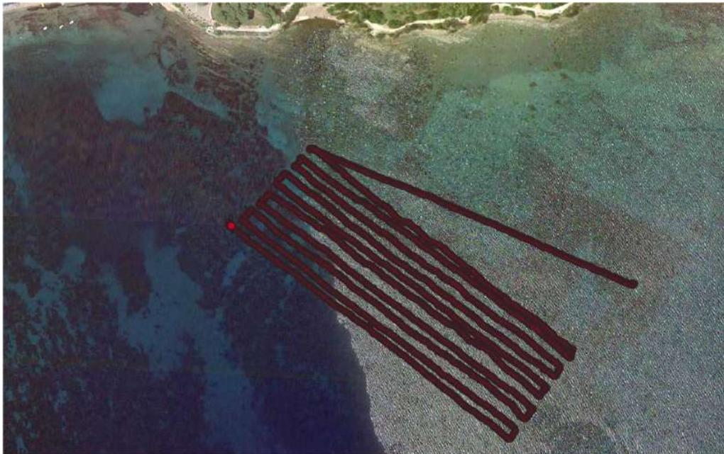
**Figura 1** - Tracciato di acquisizione Single Beam.
