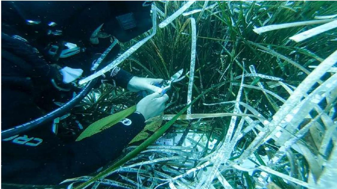
**Figura 14** - Operatore subacqueo durante la fase di asportazione e catalogazione strato fogliare da stazione di campionamento.
