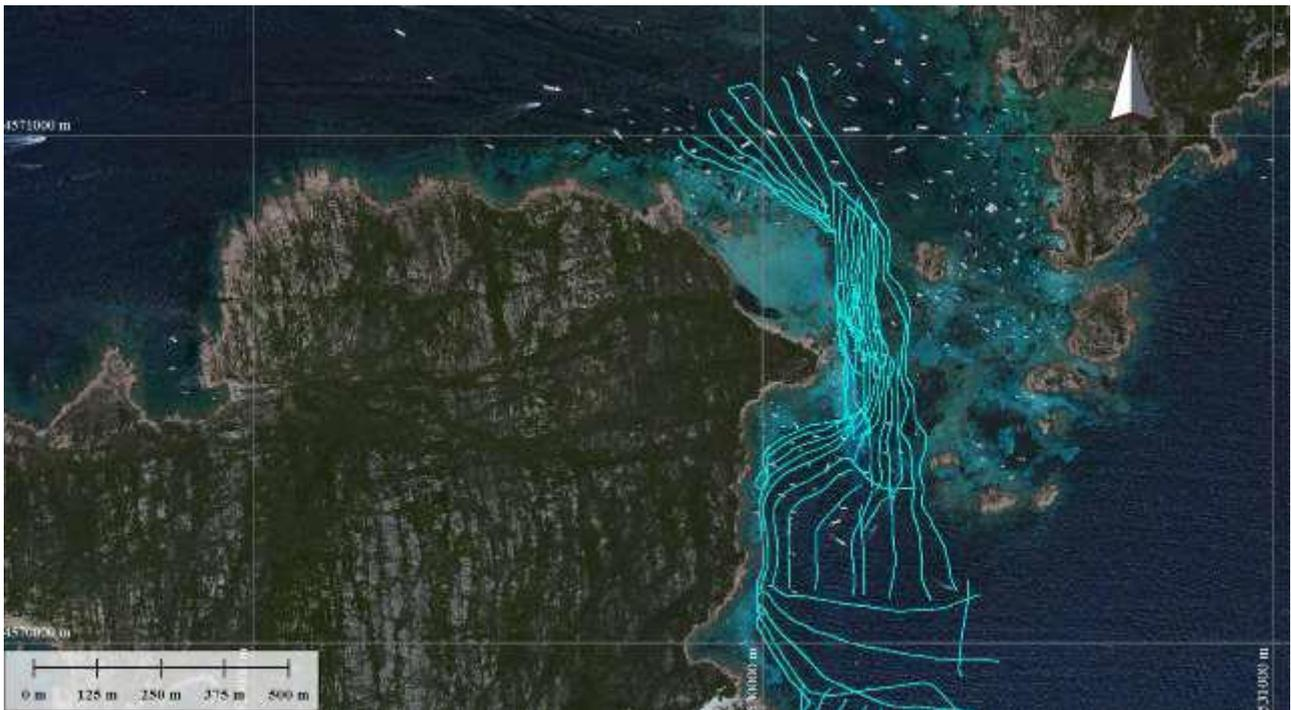
Figura 4-4 la figura mostra le linee di navigazione dell'acquisizione multibeam di fronte la spiaggia dei Cavalieri – Porto Madonna. Immagine tratta da Report CNR, 2016.
