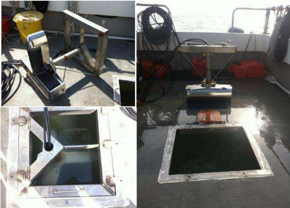
Figura 4-1 Installazione dei trasduttori del Teledyne Reson SeaBat 7125 con moon-pool.
