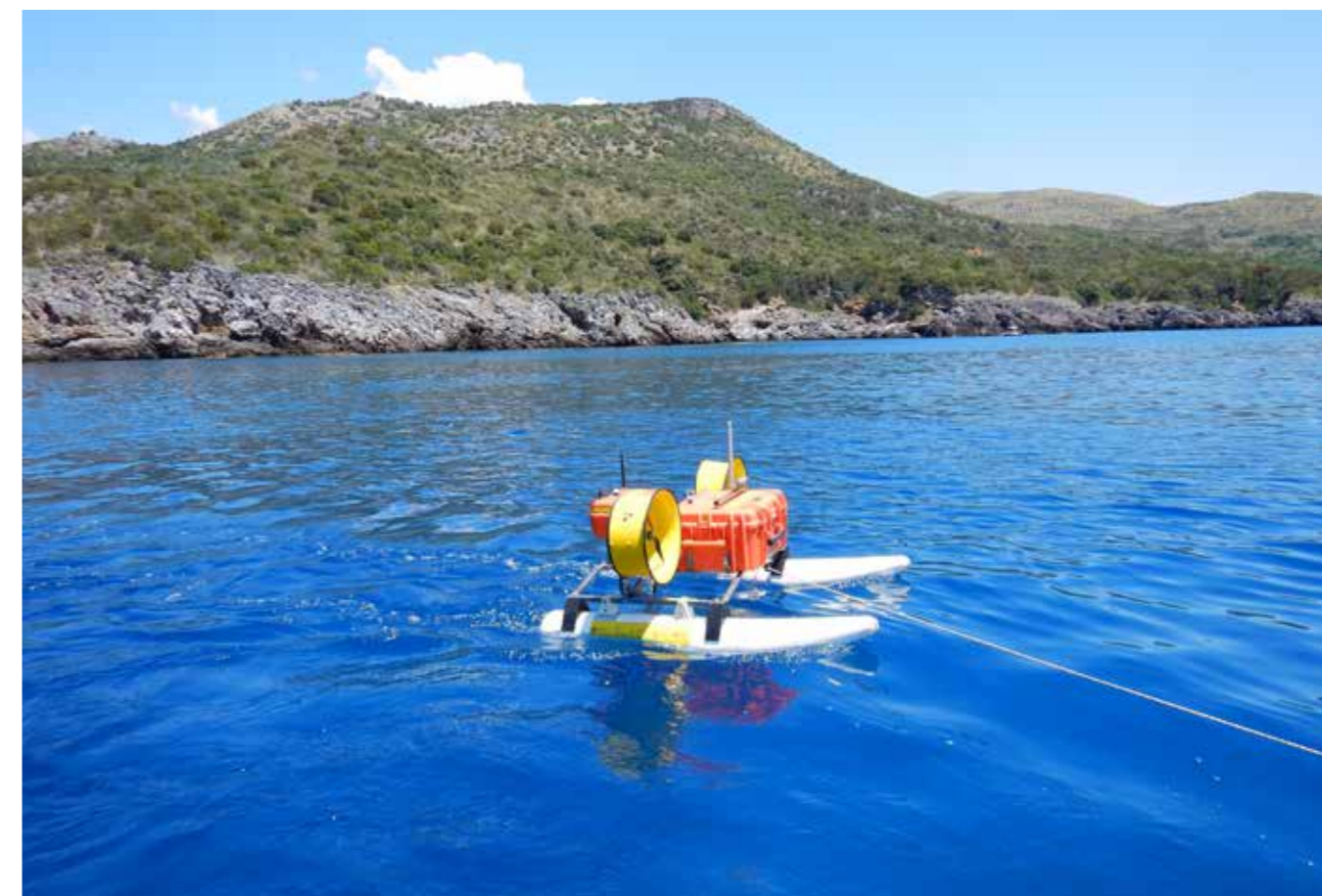
Figura 4.3 Veicolo Autonomo di Superficie DEVSS. Development vehicle for scientific survey (DEVSS).
